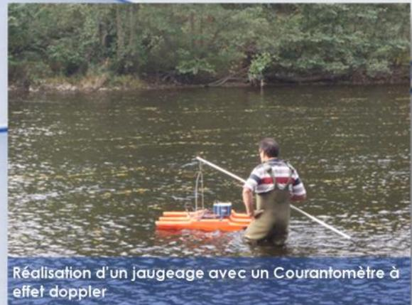
Réalisation d'un jaugeage avec un Courantomètre à effet doppler
